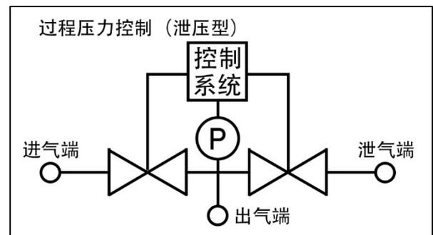
GT233 过程控制型 (泄压型) 压力控制器
