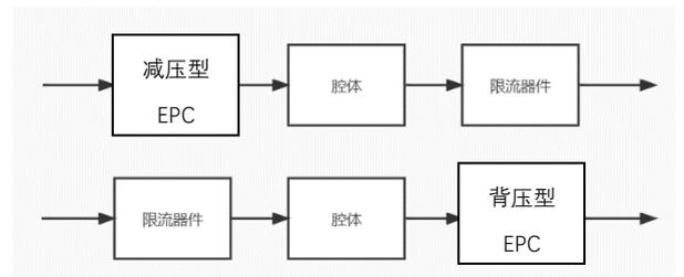
腔体压力控制可根据应用场景选择减压型和背压型压力控制器。使用过程中，需要加入限流器件，限流器件可以选择气阻或流量控制器。
