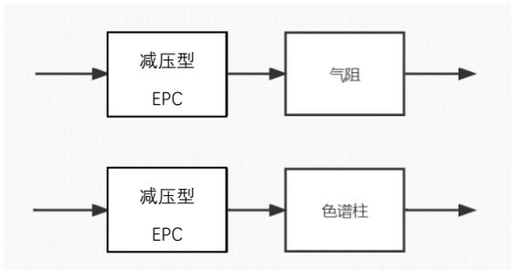
在气相色谱、分析测试设备、生物医药等领域，需要微小流量或恒定流量控制，可以采用压力控制器控制限流器件（气阻、色谱柱等）前端压力，以获取限流器件（气阻、色谱柱等）通过恒定流量。
